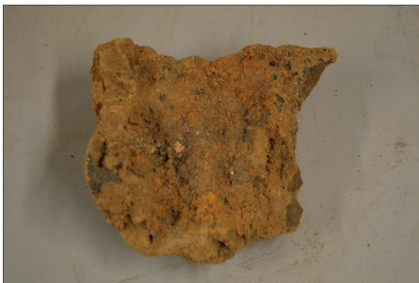
Plate 76, Basal tap slag
