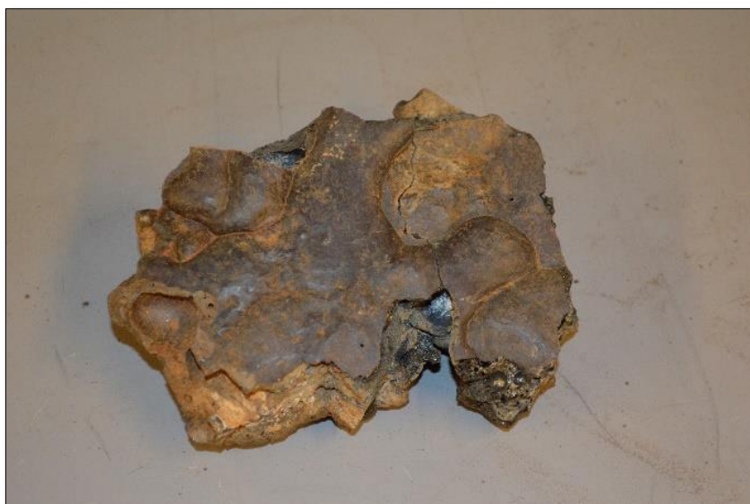
Plate 77, 'Typical' tap slag
