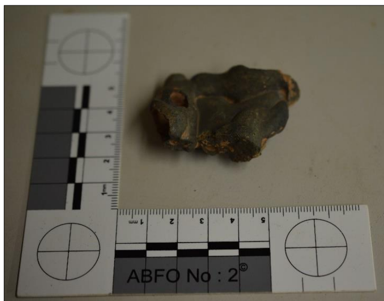
Plate 43, 'Typical' tap slag
