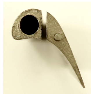
(d) Entry point of sensors into blade.
