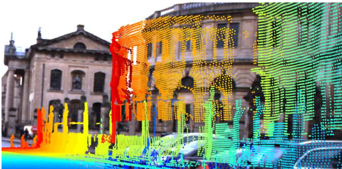
(b) 5° RPY Calibration Error
